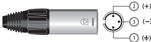
输入 INPUT 平衡连接 公座 XLR
